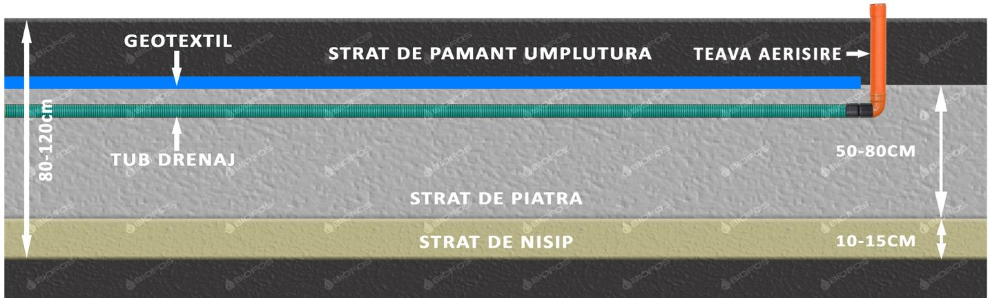
Totodata, tubul de drenaj prevazut cu orificii de scurgere, cu diametrul de 110 mm, va fi acoperit cu ajutorul unei folii geotextile. Acest pas se realizeaza inaintea ingroparii in stratul de piatra si are rolul de a preintampina infundarea drenului. La montare se va asigura o panta de scurgere cu o valoare de 1% necesara pentru un tranzit eficient al apelor.
